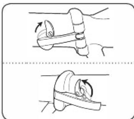
Разложите раму и рулевую колонку, переведя рычаги быстрой фиксации (эксцентрики) в положение «закрыто». Каких-либо специальных инструментов не требуется.
